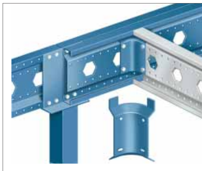
Stolpe med bjælkebeslag samt dobbeltbjælke. Rundet vinkelbeslag binder primær og sekundærbjælke sammen. Forstansede huller letter montagen.
