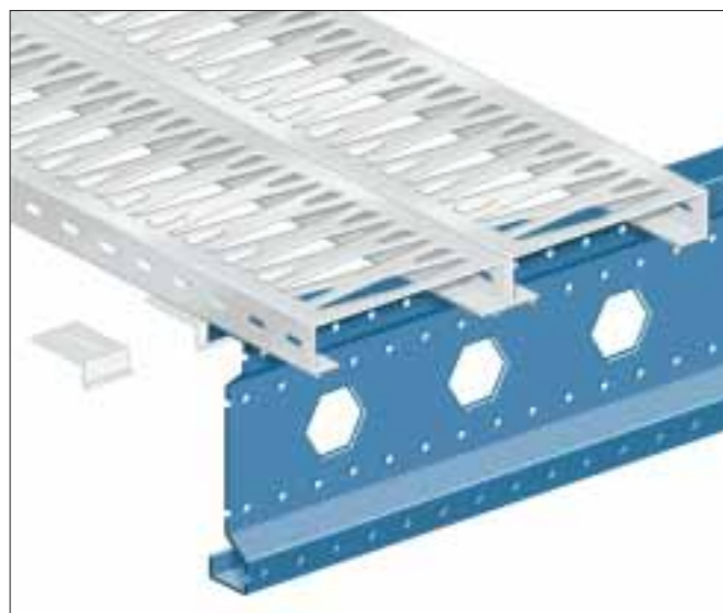
Gulvmaterialet er altid kundetilpasset. Her vises gitterriste og fastgørelse med vinkelbeslag.
