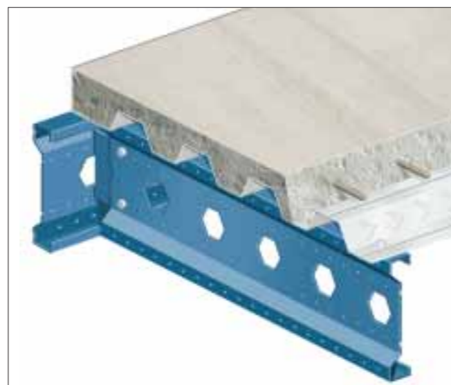
Her består gulvet af profilplade og armeret beton.
