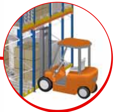
Palle kan håndteres med en standard modvægtstruck.
