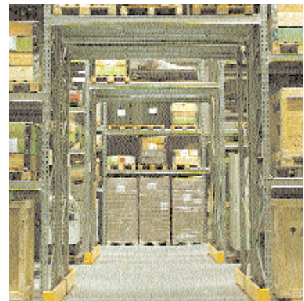
For at udnytte pladsen optimalt opbevares der paller over køregangene.
