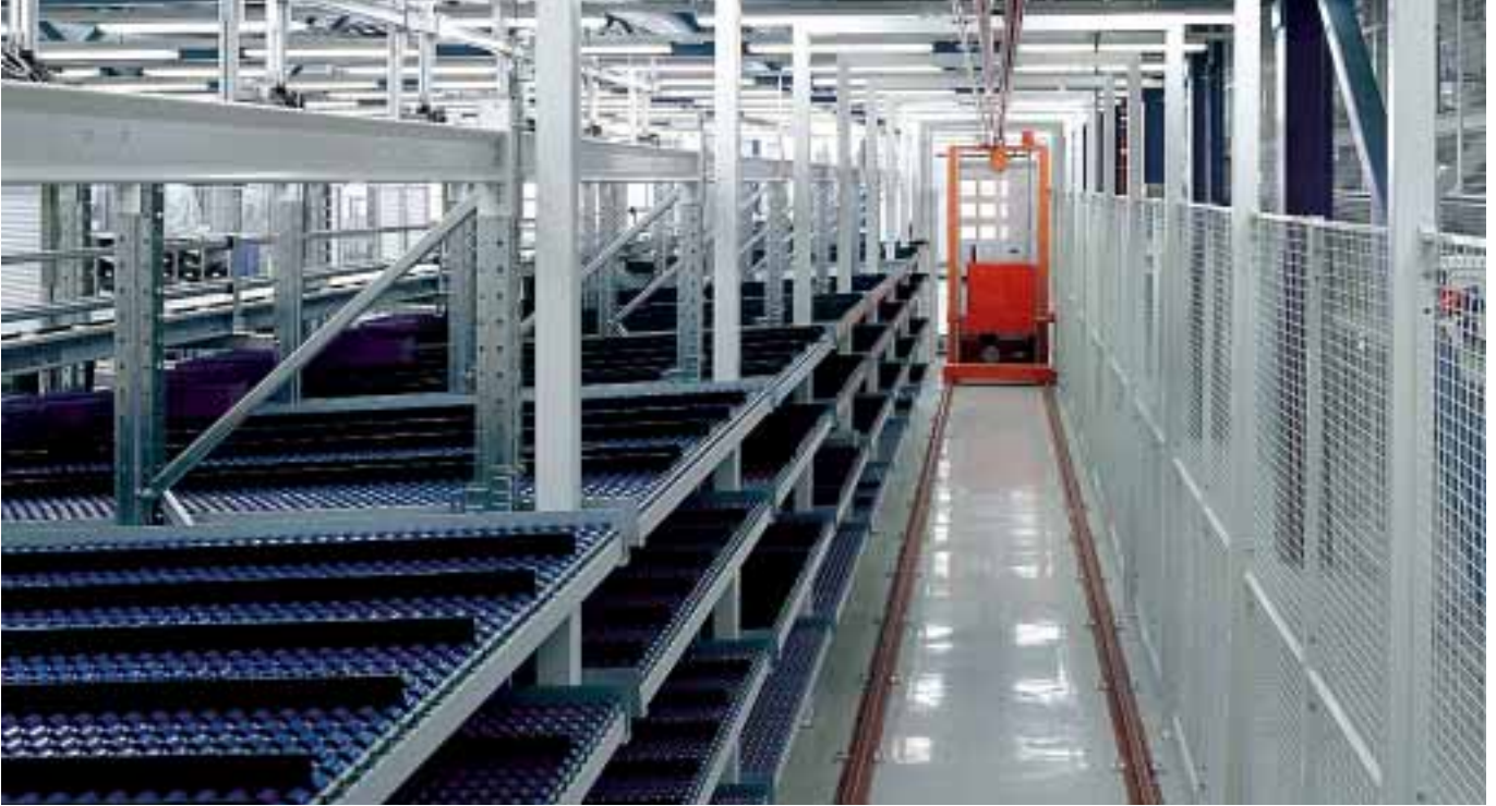
Indlæsningen i denne SELECTAFLO foretages automatisk med en speciel trolley.
