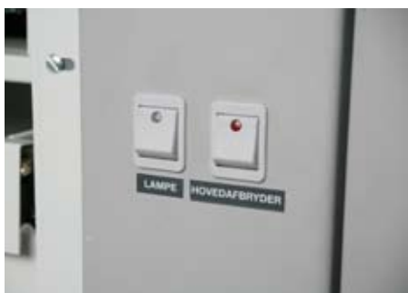
Til venstre sidder 2 kontakter: 1 til tænd/sluk af lys og en hovedafbryder.
