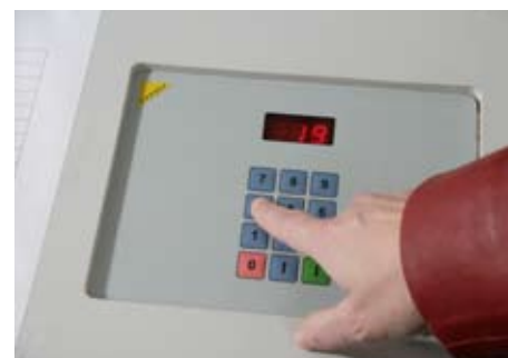
I bordfladen er nedfældet tastatur hvor det ønskede hyldenr. indtastes. Herefter køres hylden til åbningen for fremtagning.
