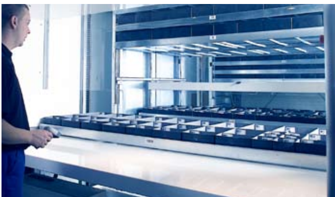
Den altafgørende skuffeudveksling i Tornado Double, der sikrer en kontinuerlig plukning, og dermed højere plukkeeffektivitet.
