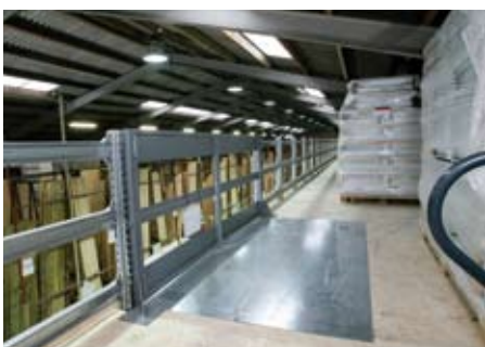
Mezzaninen er udstyret med 3 palleuser, hvor man henter / lagrer artikler der ikke håndteres så tit.
