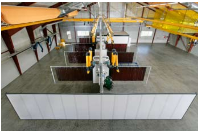
Væg-løsningen set fra oven. Der er 9 svejskabiner fordelt på hver side af væggen samt 1 lukket.
