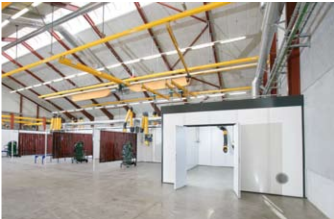
Svejskabiner dannet ved hjælp af vægssystem Cassette900 og svejsforhæng.
